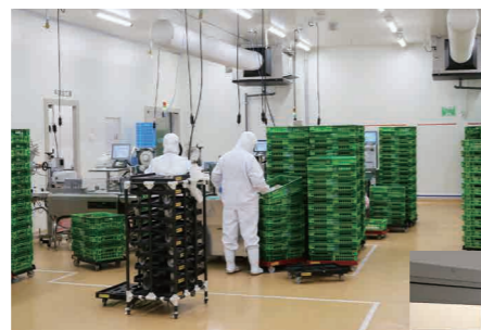
▲出荷仕分・保管室(低風速冷却器)を導入
